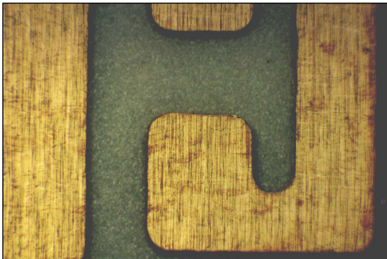
Bild 3: Detailaufnahme eines einzelnen Trägers mit Kontaktfläche auf der strukturierten Vorderseite
